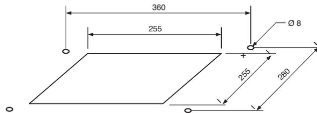
2. Posizionare il torrino sul foro predisposto e fissarlo al quadro con le viti di fissaggio in dotazione.
